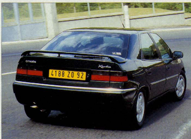
Dans ce virage à droite, le poids de la Xantia devrait écraser les pneus à l'extérieur : sur l'Activa il n'en est rien, puisqu'elle vire à plat.
